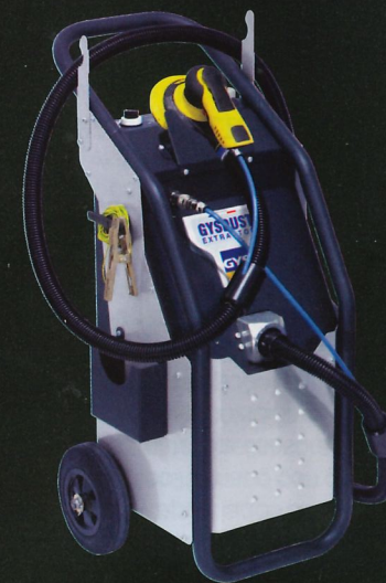
GYSDUST Extractor Aspirador neumático para polvo ATEX categoría 3
